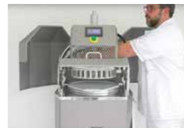
固定ボルトをゆるめて引き上げる
